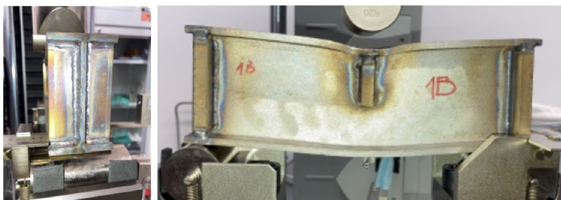
Obr. 1.22: Deformace vyztuženého nosníku na konci experimentu
