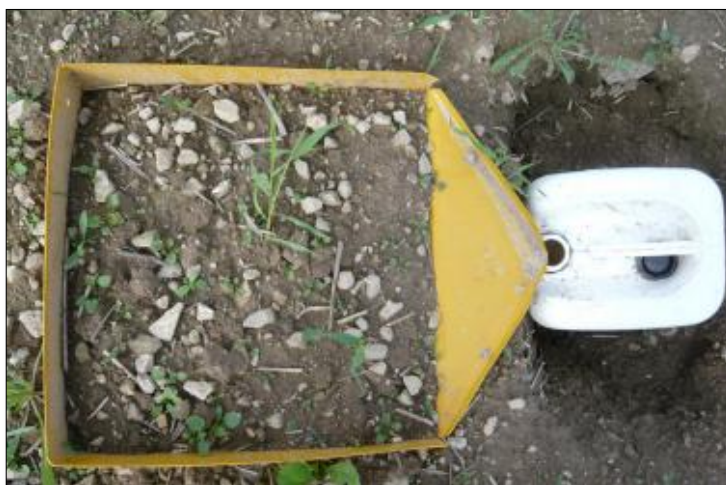
Obr.č.9: Odtoková mikroparcelka se záchytnou nádobou (online: http://www.vuzt.cz/svt/vuzt/publ/P2011/018.PDF , staženo 30.3.2017)
