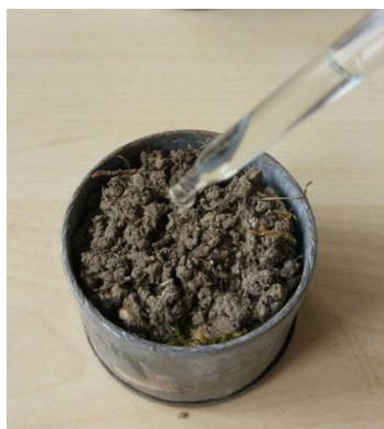
Obr.č.26: Zkouška hydrofobicity půdního vzorku
