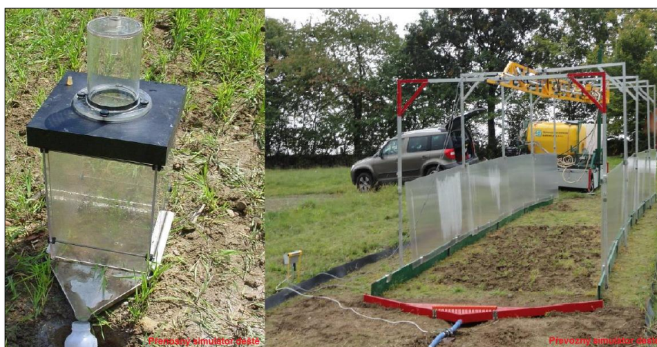
Obr.č.10: Přenosný a převozný simulátor deště (online: www.vumop.cz , www.biom.cz , staženo 31.3.2017)
