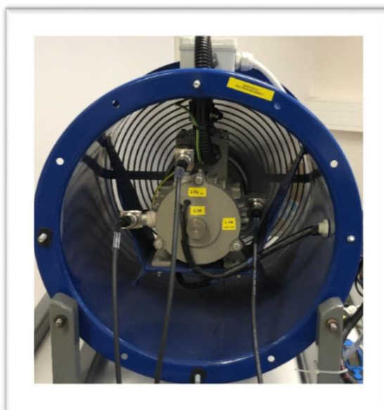
Obr. 49 Umístění snímačů vibrací
