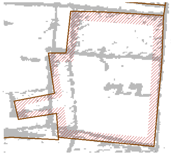
Obr. 65 Porovnání zpřesněného rastru PK a kontrolního zaměření [21]
