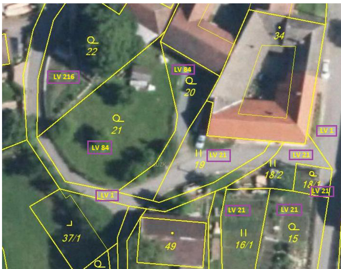
Obr. 37 Ukázka dalšího případu chybně zakreslené komunikace [20]
