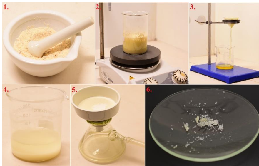
Obrázek 3.11. – dokumentace jednotlivých kroků celého postupu při izolaci kyseliny benzoové
