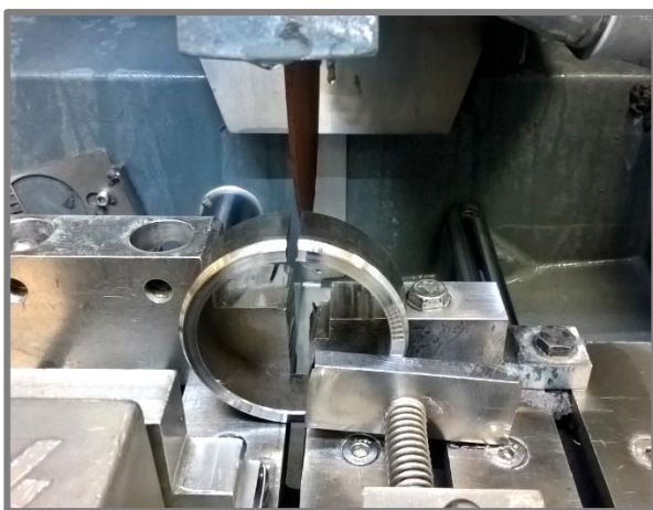
Obr. 43) a) rozřezání kroužku pro změření vnitřního pnutí, b) měření mezery posuvným měřidlem
