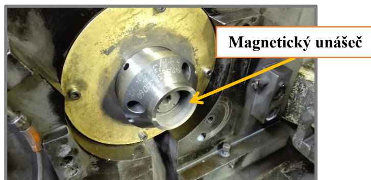
Obr. 13) Broušení vnitřního otvoru
