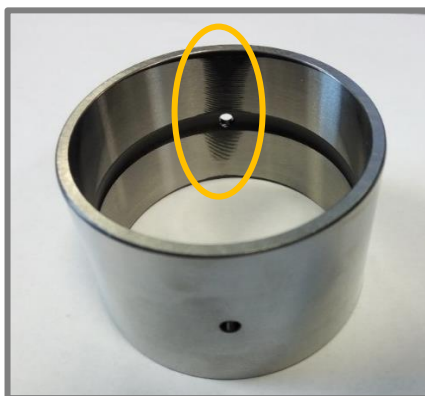
Obr. 23) Chybějící materiál na vnitřním průměru
