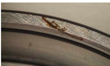
Obr. 58) Koroze na čele kroužku
