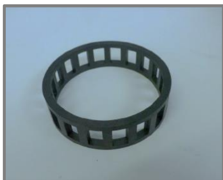
Obr. 21) a) klec ložiska b) valivé elementy ložiska - válečky[8]
