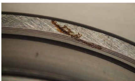
Obr. 58) Koroze na čele kroužku
