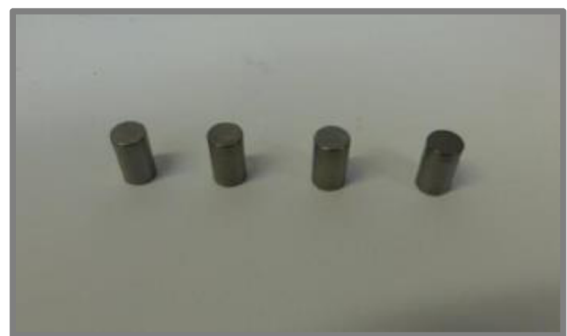
Obr. 21) a) klec ložiska b) valivé elementy ložiska - válečky[8]
