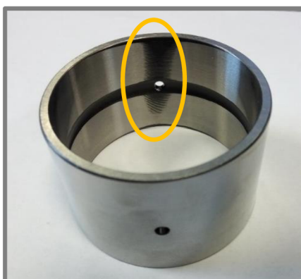
Obr. 23) Chybějící materiál na vnitřním průměru
