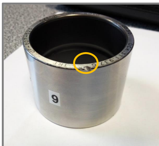
Obr. 33) Vryp na čele kroužku
