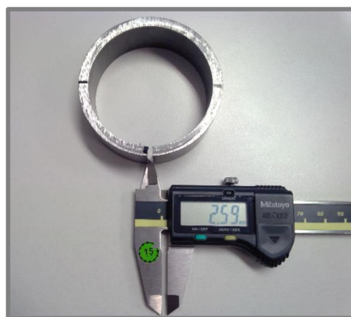
Obr. 43) a) rozřezání kroužku pro změření vnitřního pnutí, b) měření mezery posuvným měřidlem
