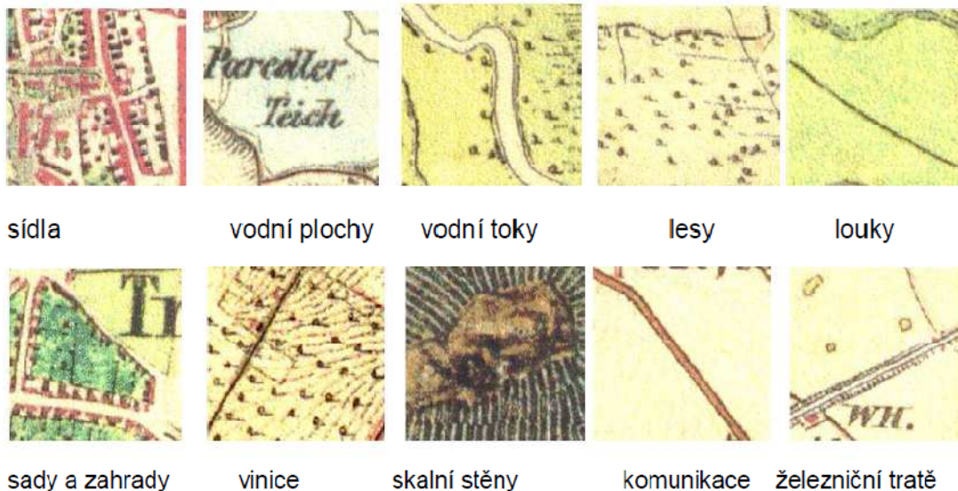
Obr. č. 5.3 : Ukázka z interpretačního klíče II. vojenského mapování. Vlastní návrh. Zdroj dat: Geolab, online.
