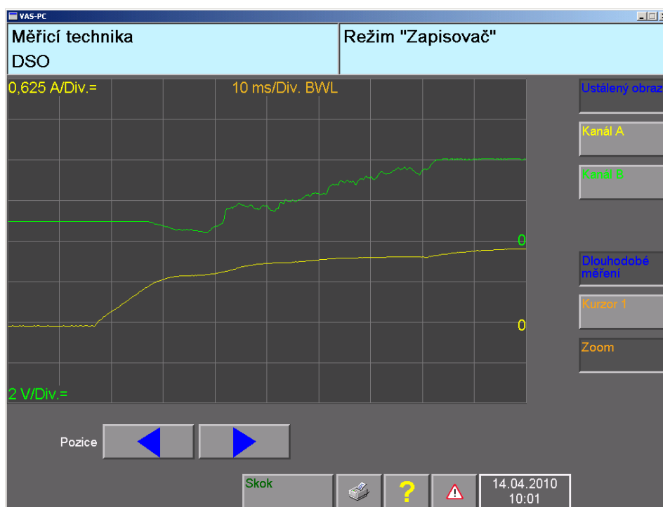
Obr. 6-9 Vzorový oscilograf pro 2 kanálový osciloskop VAS 5051, AGR – Chybná funkce [13]
