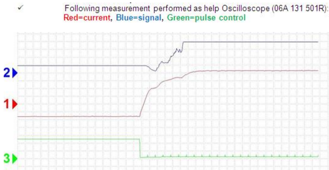
Obr. 6-7 Záznam signálů AGR ventilu [22]
