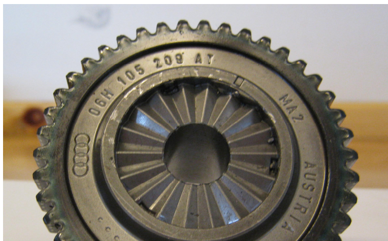
Obr. 6-5 Poškození spodního rozvodového kola [13]
