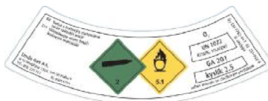
Obrázek č. 4 - Označení tlakové lahve nálepkou dle dohody ADR
