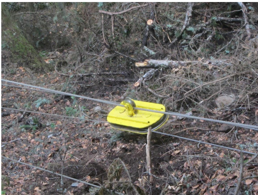
Obrázek 5: Lanáč a napínací buben nosného lana
