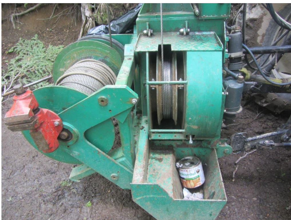
Obrázek 5: Lanáč a napínací buben nosného lana
