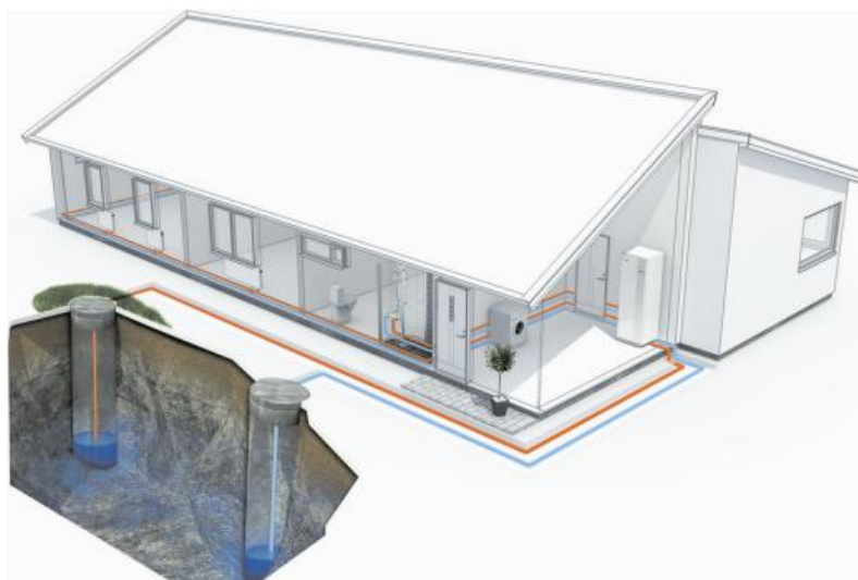
Obrázek 2.4 TČ voda-voda, odběr tepla z podzemní vody [39].
