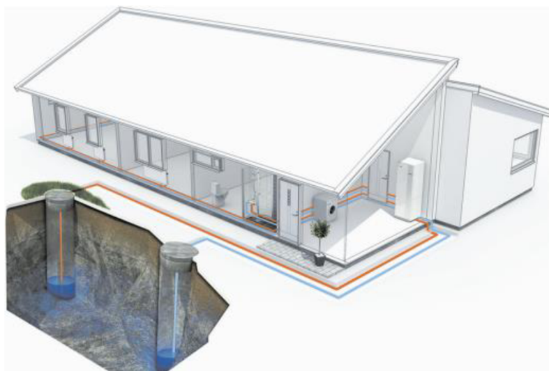
Obrázek 2.4 TČ voda-voda, odběr tepla z podzemní vody [39].
