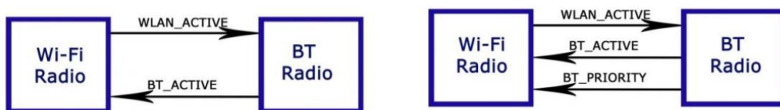
Obrázek 5 - TDM se zapojením přes 2 a přes 3 dráty [31]
