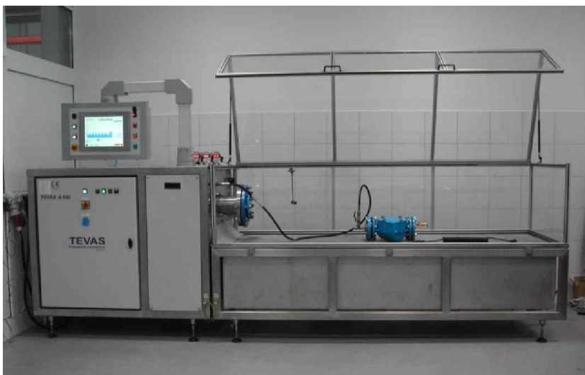
Obr.5 Zařízení pro dlouhodobé testování armatur statickým a dynamickým tlakem [6]
