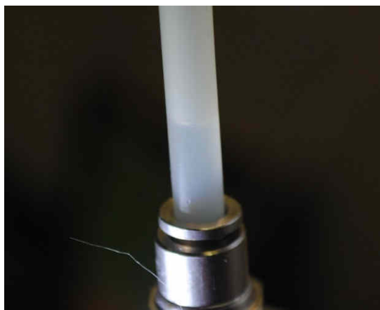
Obr.6 Vodní hladina v hadici při tlaku 998 kPa
