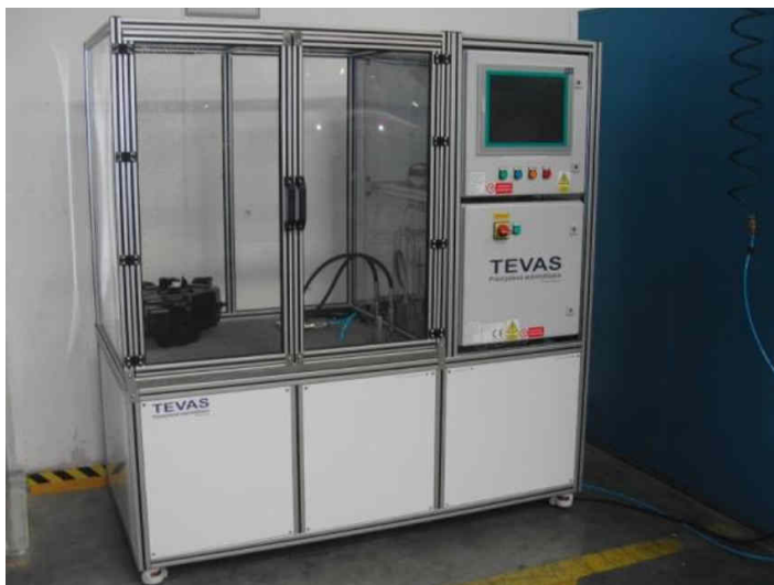
Obr.3 Zařízení pro hydrostatické testování plastických nádrží [6]
