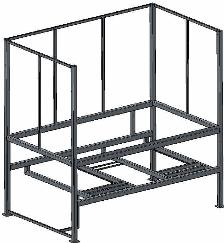
Obr.31 Svařovaný rám testovacího zařízení (model vytvořený v programu PTC CREO 2 Parametric)
