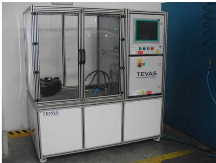
Obr.3 Zařízení pro hydrostatické testování plastických nádrží [6]
