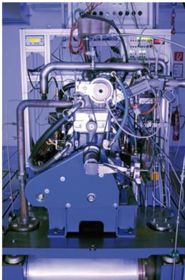
Obrázek 5: Spalovací motor na vodíkové palivo – BMW [12]
