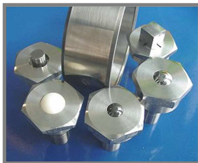
Obr. 2-14 Typy a velikosti tělísek – metoda Pin-on-ring [27]
