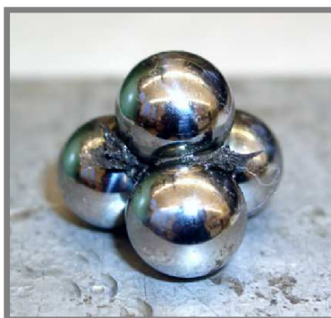
Obr. 2-7 Konec testu-svaření kuliček [23]
