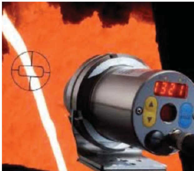
Obr. 16: Měření teploty tekutého kovu během lití pomocí pyrometru [14].
