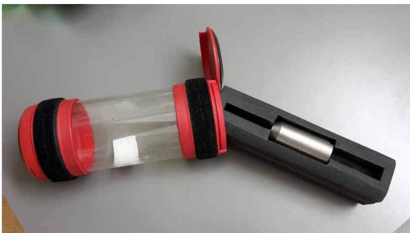
Obrázek 9 - Transportní pouzdro na radioaktivní injekci s wolframovým stíněním
