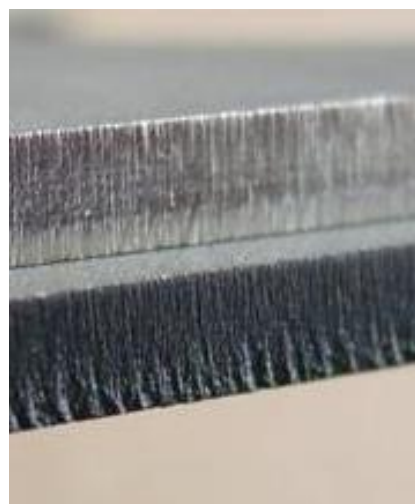
Obr. 10 Kvalita plochy u tavného (horní) a oxidačního řezání [5]
