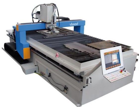
Obr. 5 Plazmový řezací stroj Vanad KOMPACT [18]
