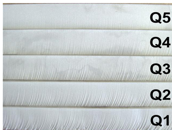
Obr. 9 Řezné plochy dle kvality řezání [15]
