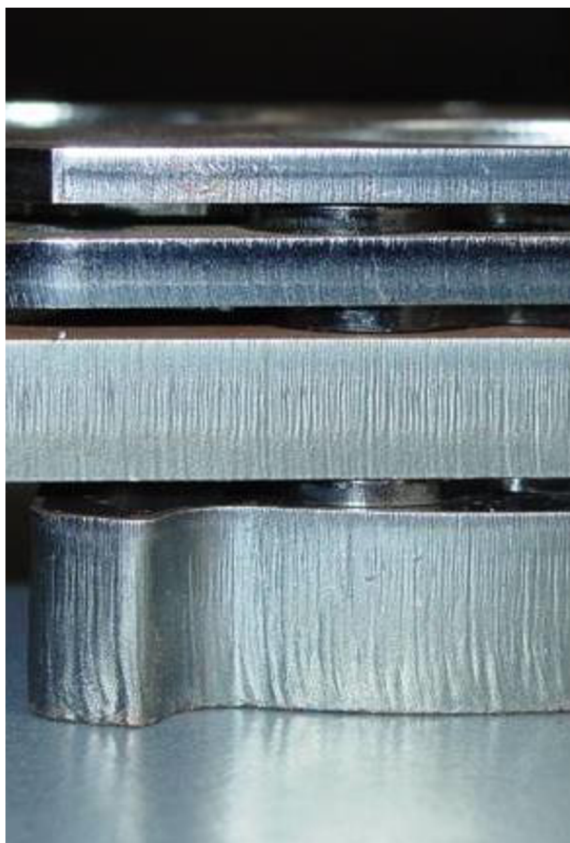
Obr. 13 Jakost řezné plochy v tloušťce od 3 do 15 mm [5]
