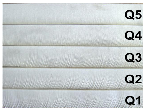
Obr. 9 Řezné plochy dle kvality řezání [15]
