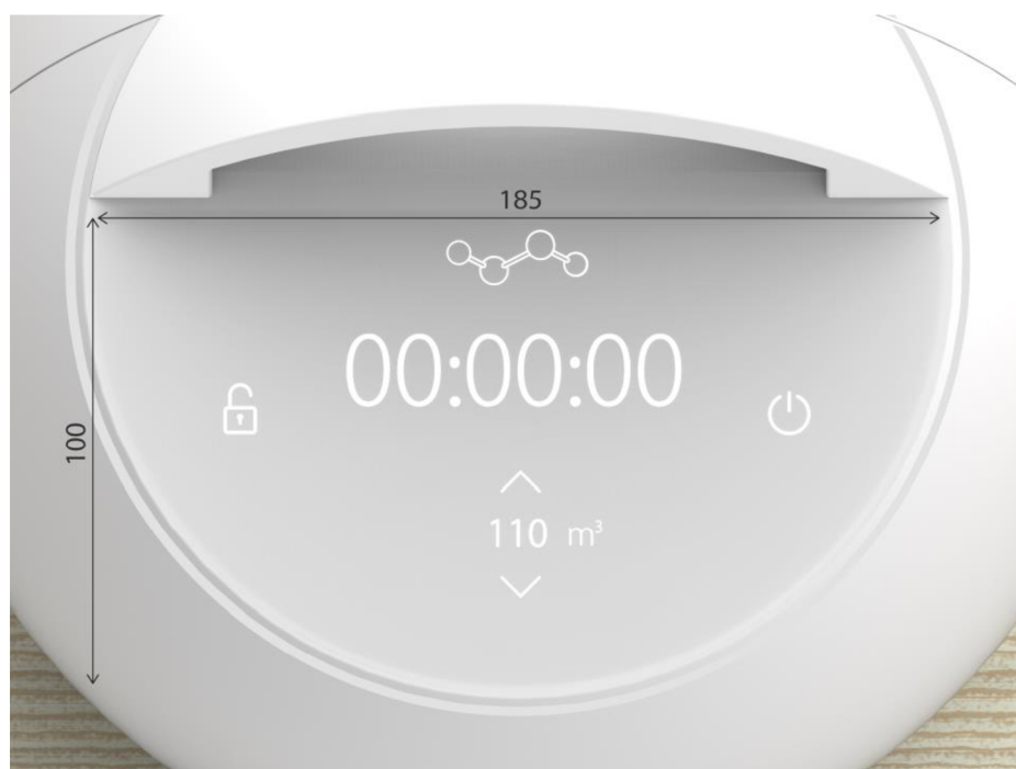
Obr. 6-10 Rozmery ovládacieho panelu
