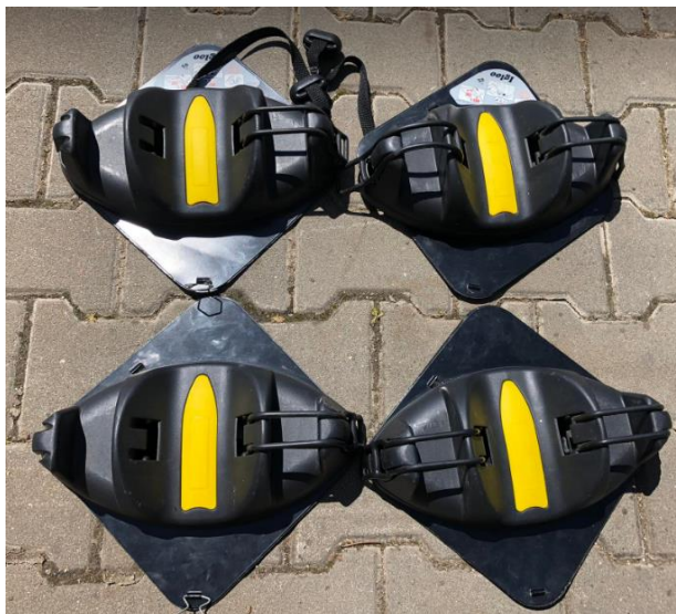
Obr. 19 Pomocné magnetické nosiče pro přichycení střešního boxu na vozidlo bez hagusů [vlastní]
