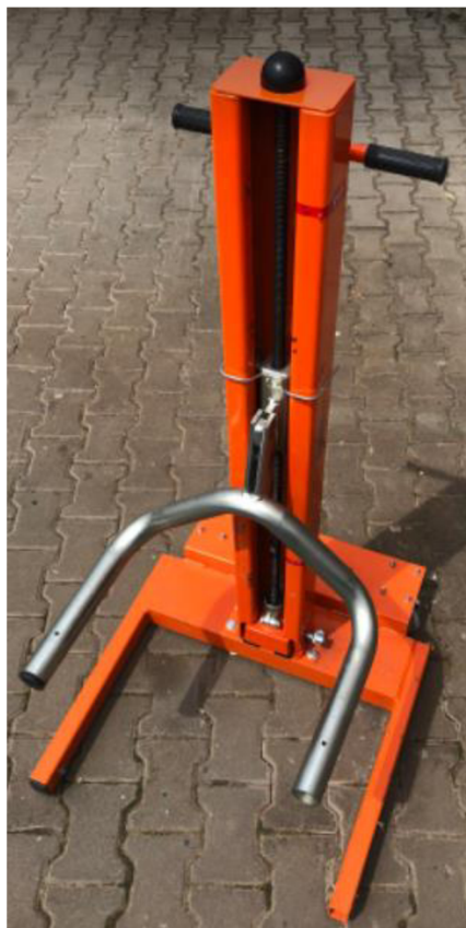
Obr. 18 Nápravový zvedák Easy-lift [vlastní]
