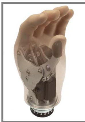
Obr. 7 Myoelektrická protéza Ottobock
