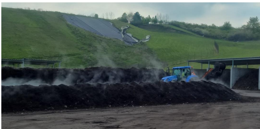
Obr. 10: Pásová zakládka na volné, vodohospodářsky zabezpečené ploše
