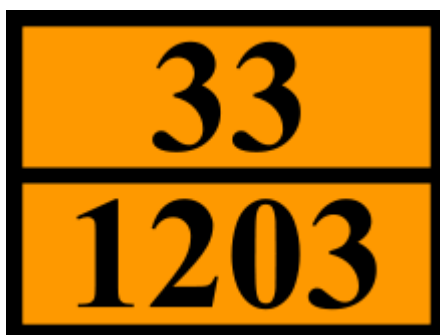
Obr. 1 – označení automobilů podle systému Kemler kód a UN kód
