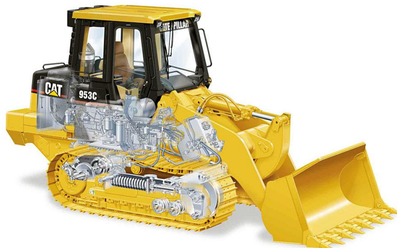
Obr. 7 Částečný řez čelního pásového nakladače firmy Caterpillar
