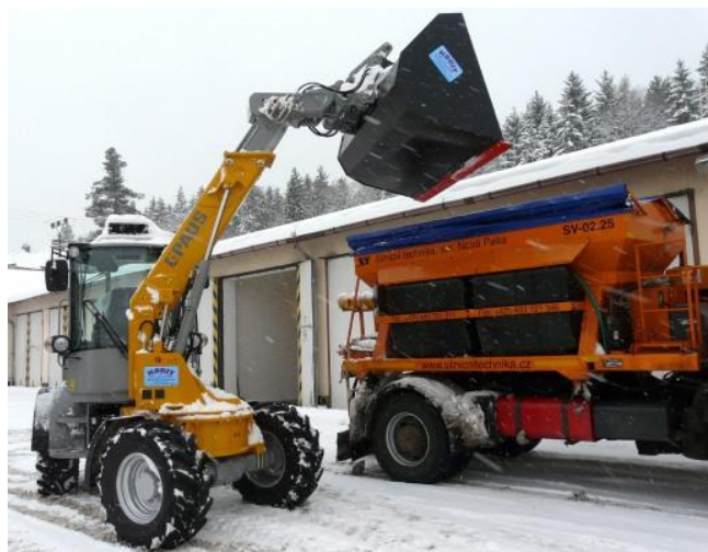
Obr. 8 Otočný nakladač firmy Paus při nakládce
