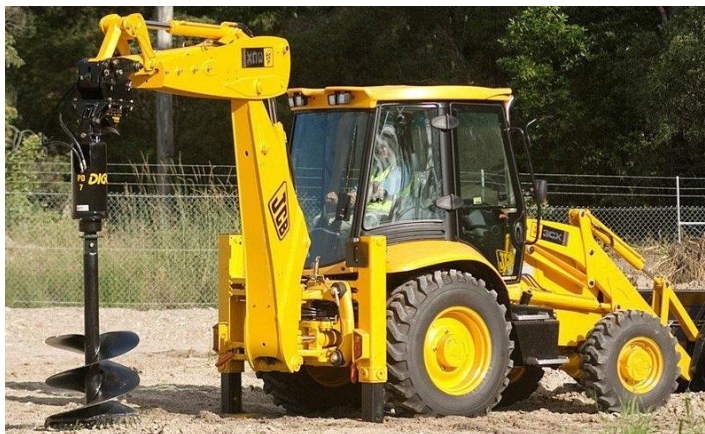
Obr. 3 Šnekový vrták připevněn na čelním kolovém nakladači
