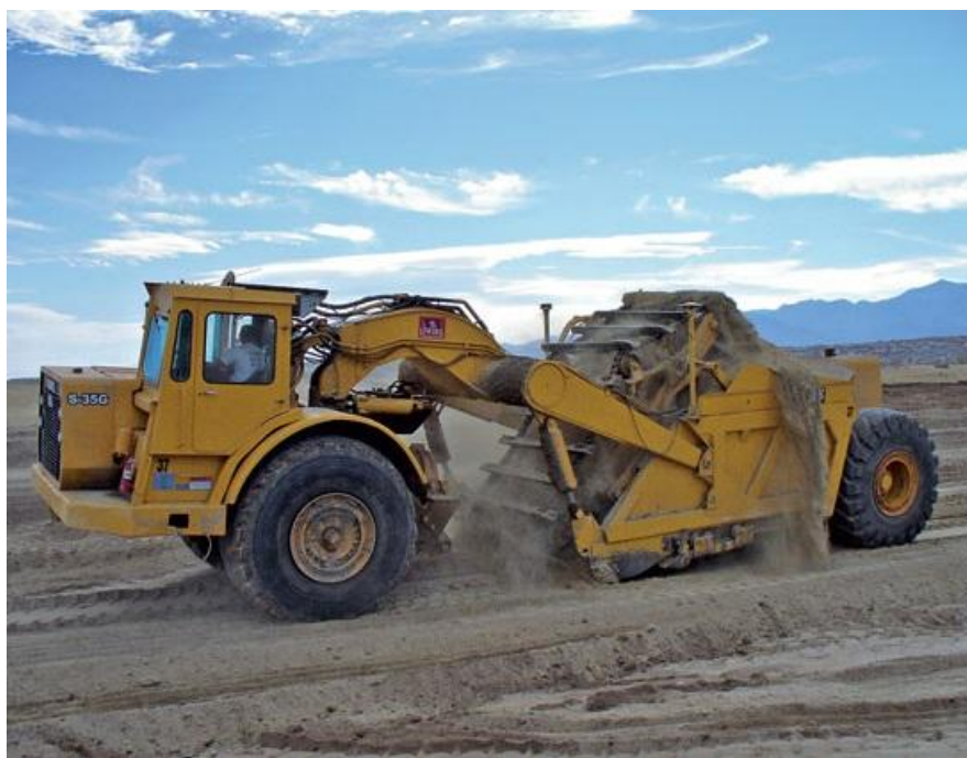
Obr. 12 Elevátorový skrejpr při těžbě
