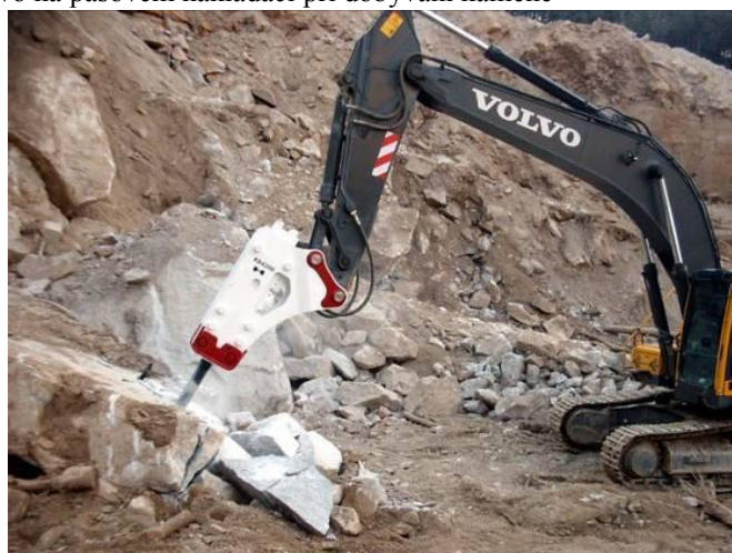
Obr. 4 Hydraulické kladivo na pásovém nakladači při dobývání kamene
