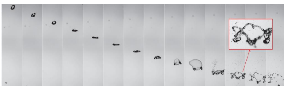
Obrázek 3: Schéma tříštění padající kapky (www.meteopress.cz)
