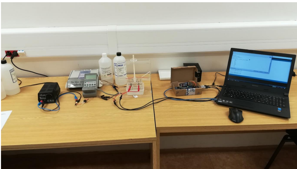
Obrázek 25 Pracoviště při měření kalibračních roztoků
