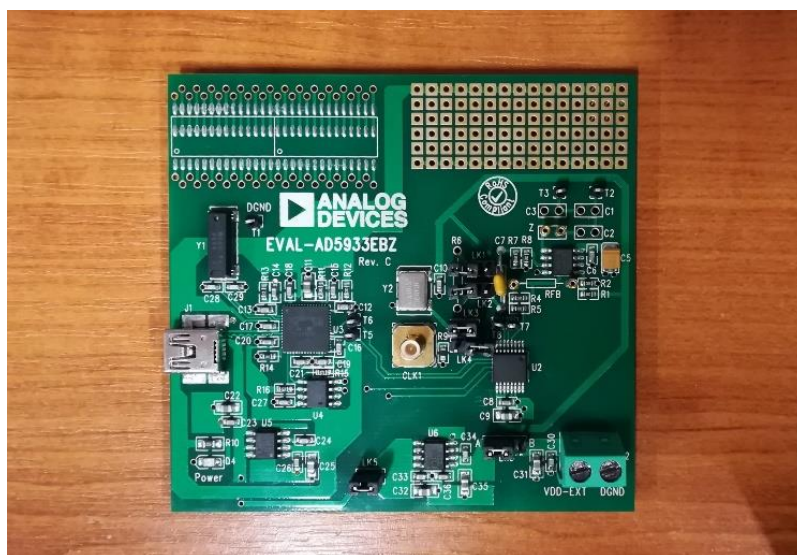
Obr. 17 Vývojový kit EVAL-AD5933EBZ
