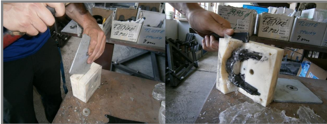
Obr. 5-14 Vyberanie korunky z formy
