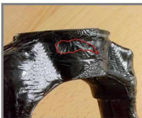
Obr. 6-3 Defekt spôsobený nahromadením strečovej fólie
