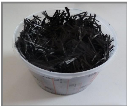
Obr. 5-8 Nastrihané karbónové vlákno
