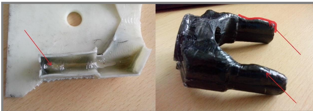
Obr. 6-2 Defekt spôsobený strečovou fóliou
