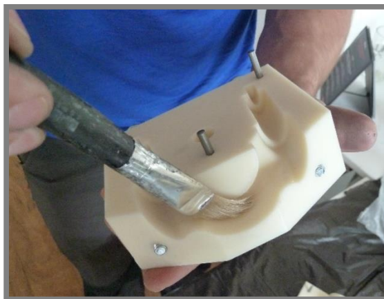
Obr. 5-9 Natieranie jednotlivých dielov separátorom
