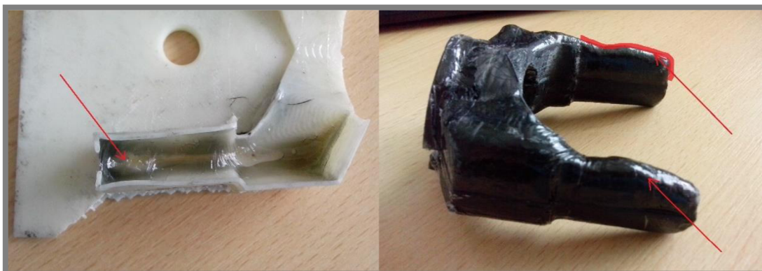
Obr. 6-2 Defekt spôsobený strečovou fóliou
