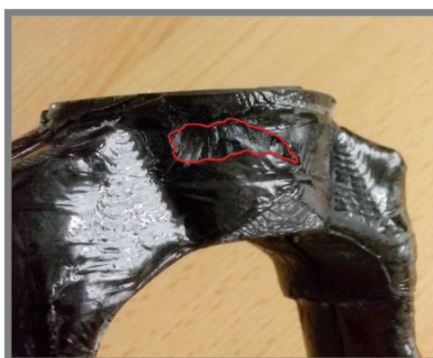
Obr. 6-3 Defekt spôsobený nahromadením strečovej fólie
