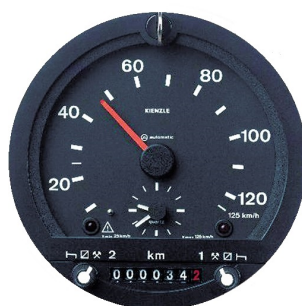
Obr. 3: EC kruhový tachograf, upravené podľa [11]
