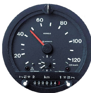
Obr. 3: EC kruhový tachograf, upravené podľa [11]
