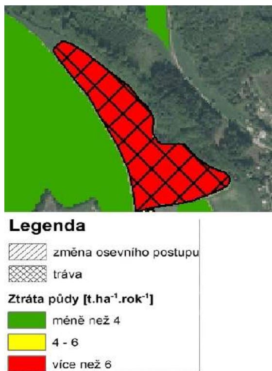
Obr. 25: Protierozní opatření na půdním bloku ohroženém vodní erozí č. 4 – k. ú. Horní Bukovina
