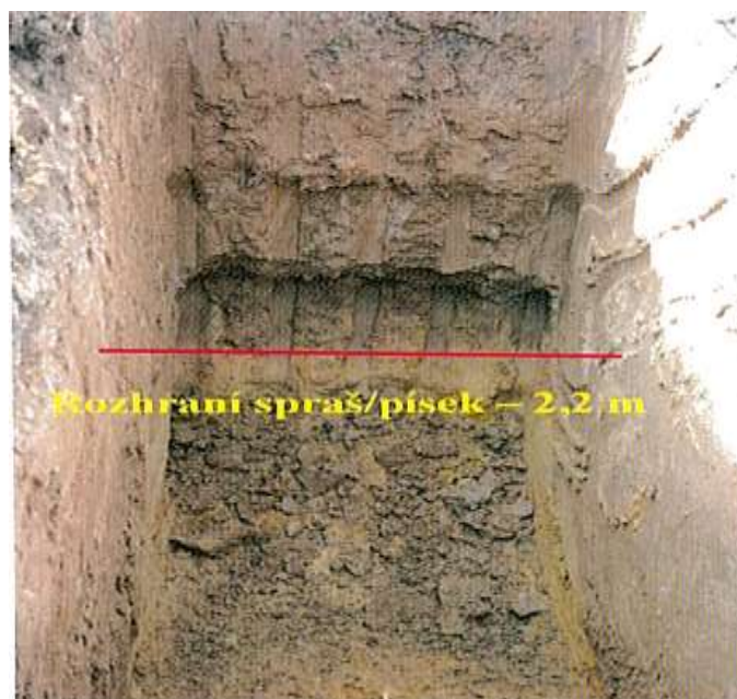
Obr. 20: Zemní profil v kopané sondě (Tůma, 2017)
