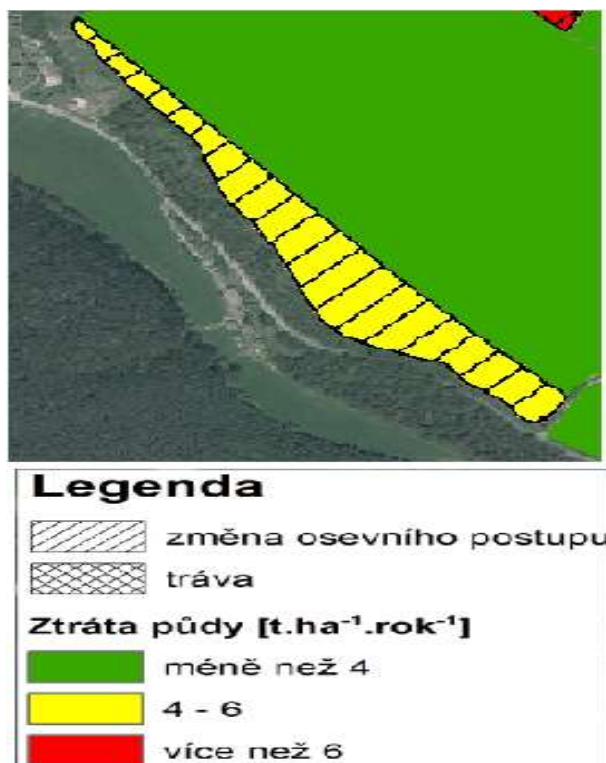
Obr. 22: Protierozní opatření na půdním bloku ohroženém vodní erozí č. 1 – k. ú. Horní Bukovina
