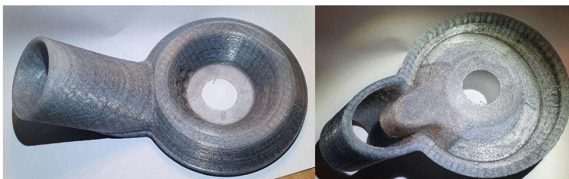
Obrázek 30. Vytiskněný model na neupravené tiskárně
