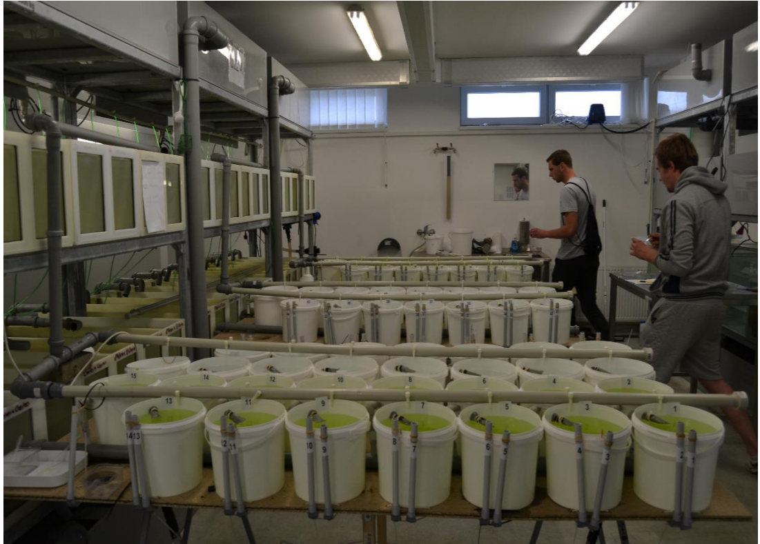
Obrázek č. 6: pohled na experimentální recirkulační systém (archiv autora).
