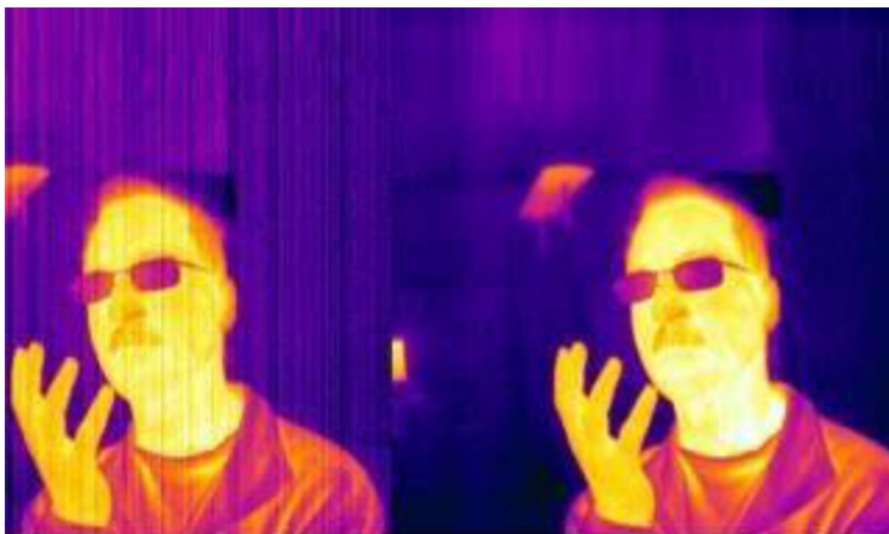
21.Obrázek Snímek bez aplikovaných korekcí signálu je vlevo, zatímco snímky se správnými algoritmy zpracování signálu aplikovanými na příslušné obvody jsou vpravo. [27]
