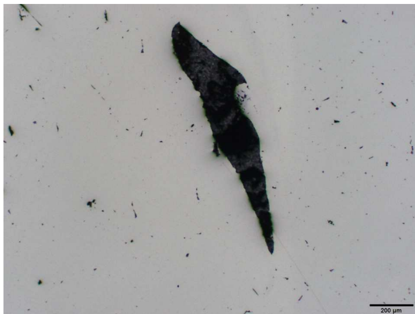
Obr. 67 vada na rozhraní svarový kov - austenit
