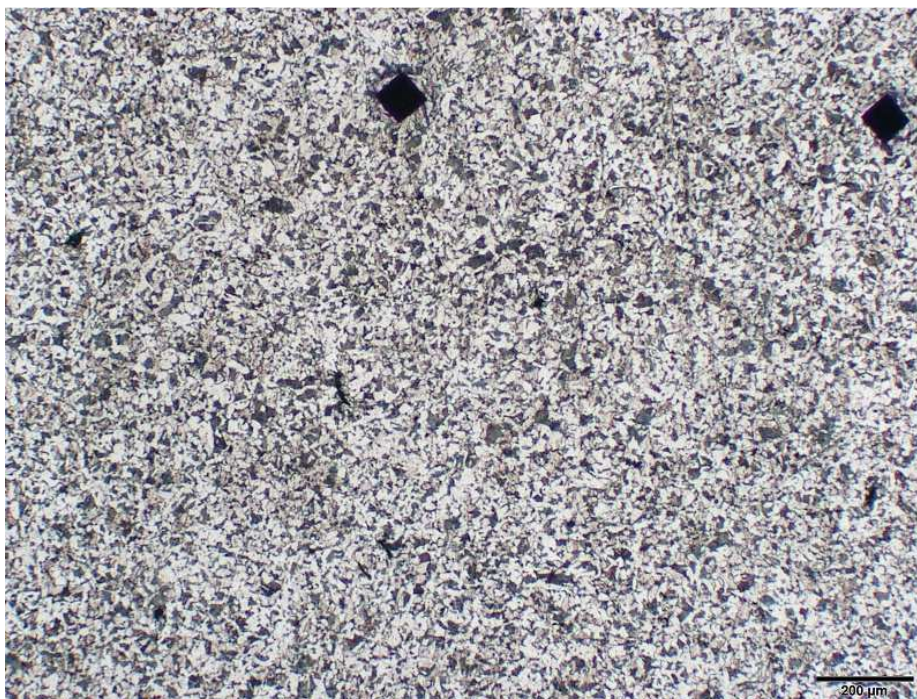
Obr. 43 Mikrostruktura základního materiálu v lící oblasti svaru
