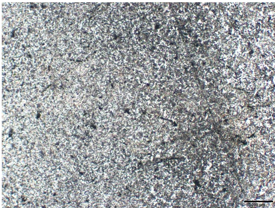
Obr. 53 Mikrostruktura tepelně ovlivněné oblasti ve střední části svaru
