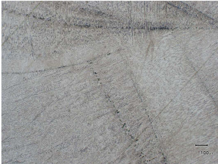
Obr. 84 Mikrostruktura svarového kovu ve střední části svaru
