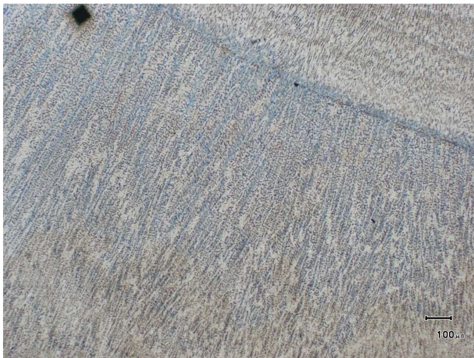
Obr. 92 Mikrostruktura svarového kovu v kořenové části svaru
