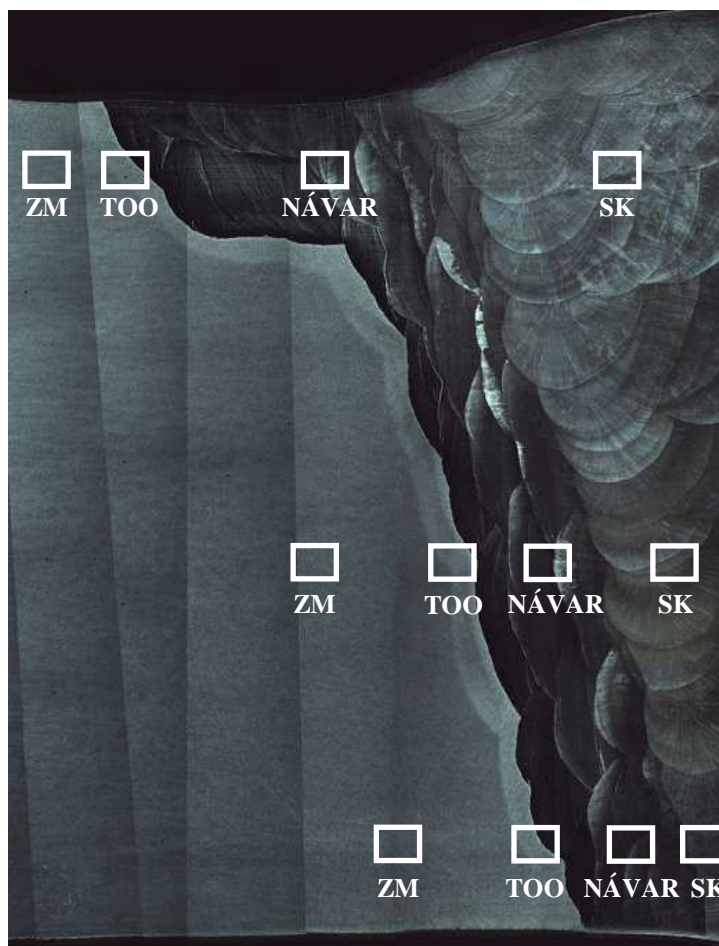
Obr. 41 Místa pozorovaných mikrostruktur na svarovém spoji
