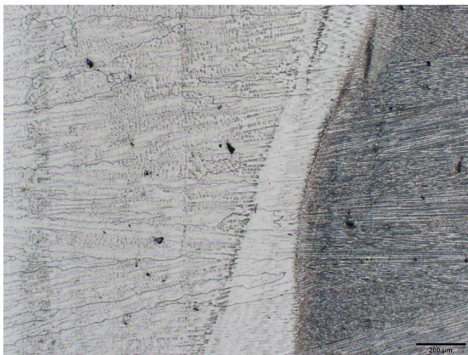
Obr. 63 Mikrostruktura návaru v kořenové části svaru
