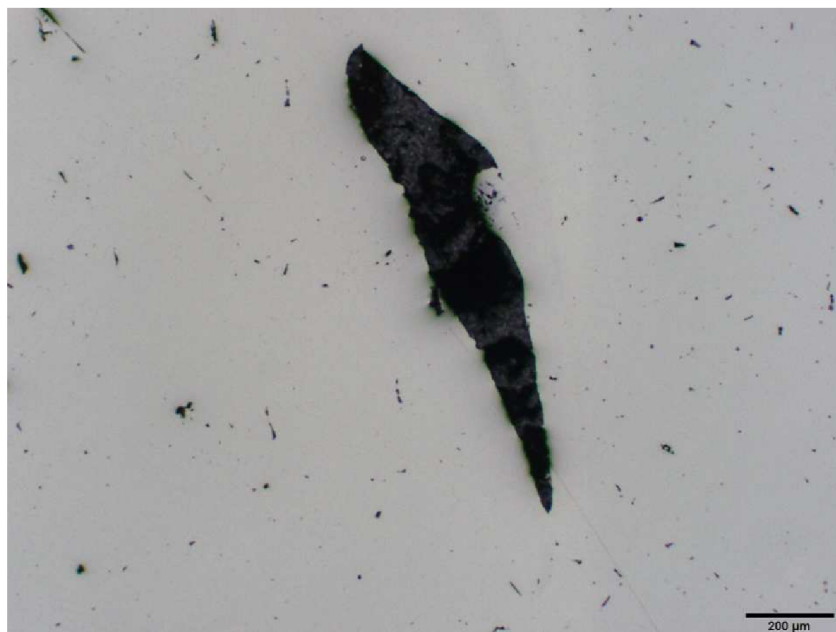
Obr. 67 vada na rozhraní svarový kov - austenit
