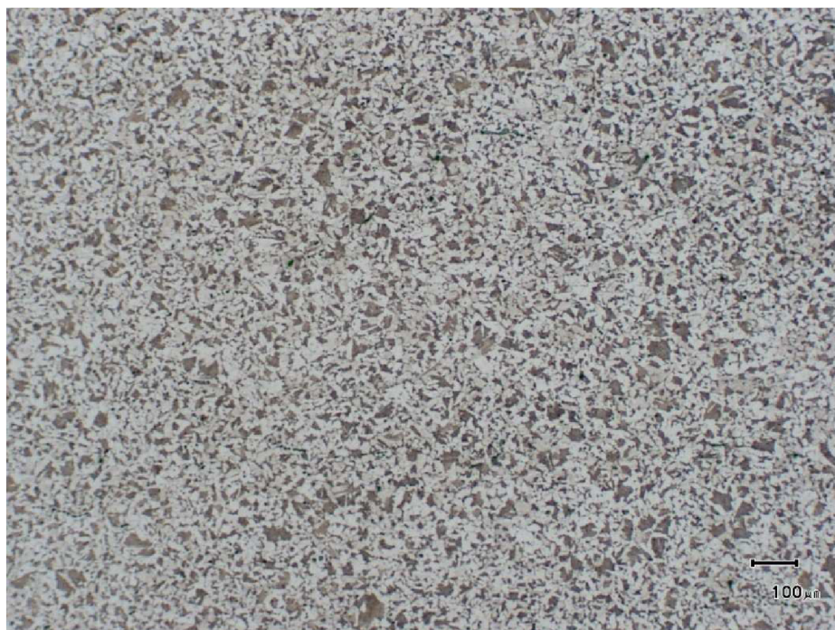
Obr. 86 Mikrostruktura základního materiálu v kořenové části svaru
