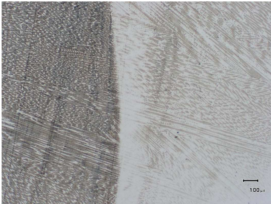
Obr. 74 Mikrostruktura návaru v lící oblasti svaru
