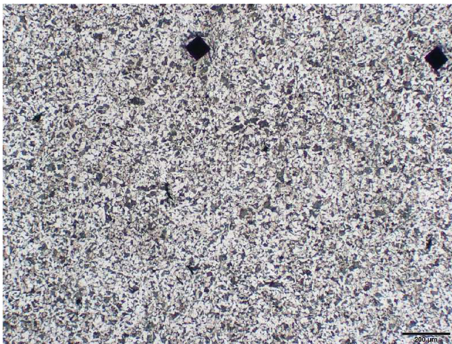
Obr. 43 Mikrostruktura základního materiálu v lící oblasti svaru
