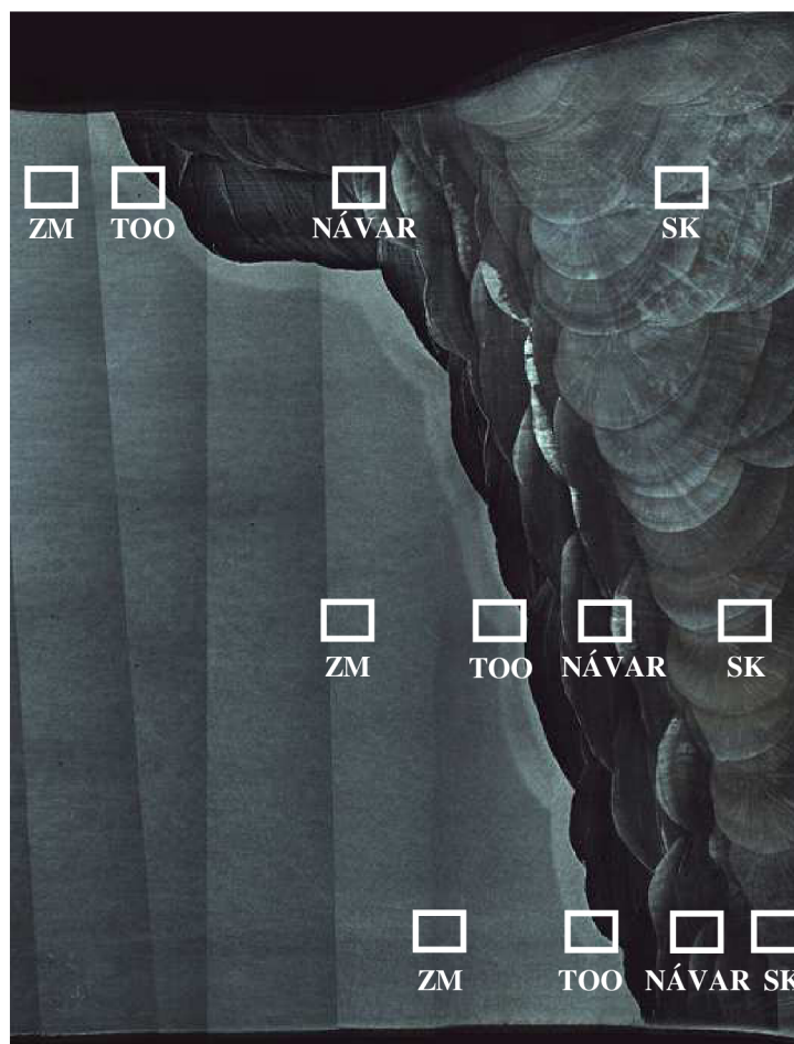
Obr. 41 Místa pozorovaných mikrostruktur na svarovém spoji
