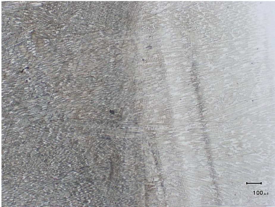
Obr. 82 Mikrostruktura návaru ve střední části svaru
