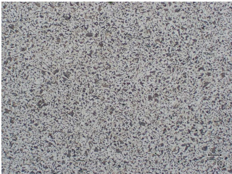
Obr. 70 Mikrostruktura základního materiálu v lící oblasti svaru
