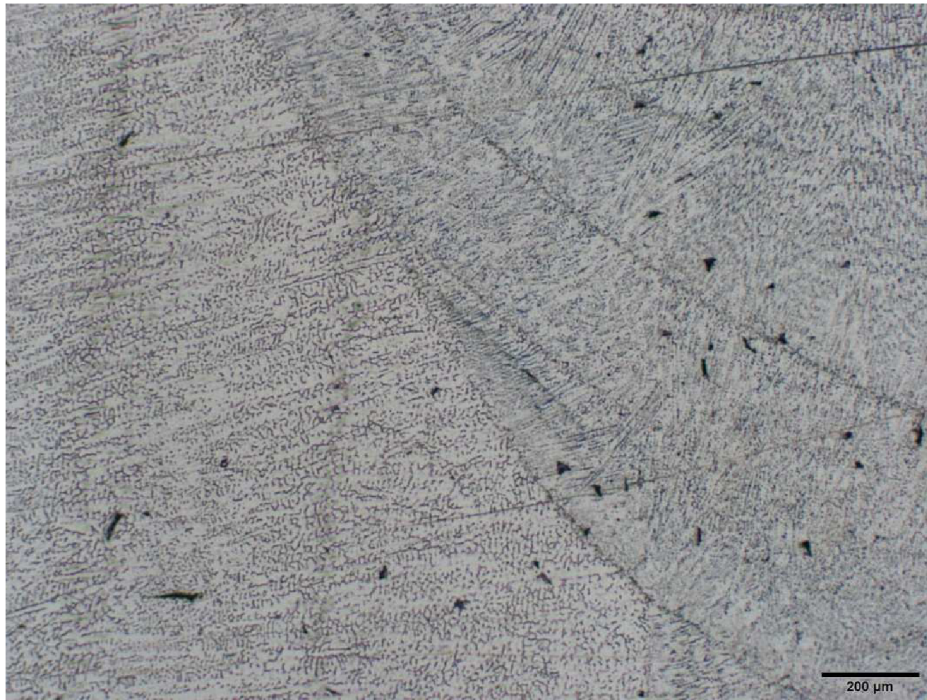
Obr. 65 Mikrostruktura svarového kovu v kořenové části svaru
