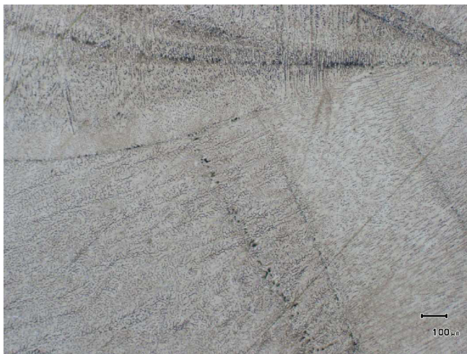
Obr. 84 Mikrostruktura svarového kovu ve střední části svaru
