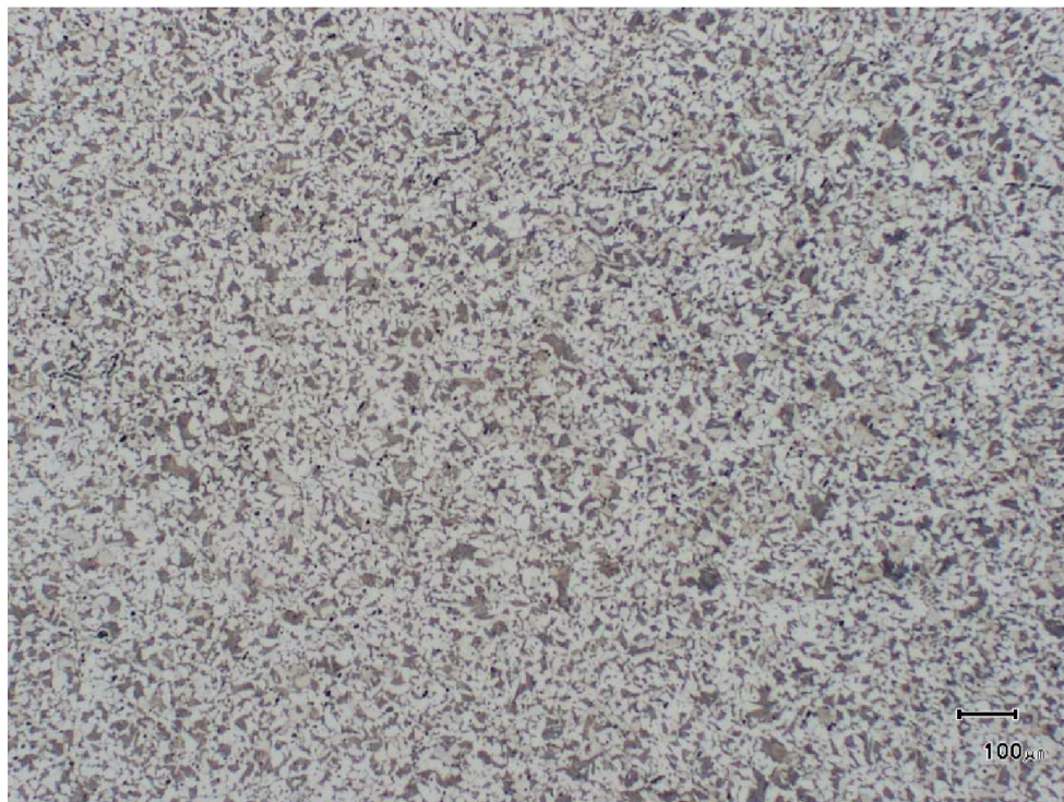
Obr. 78 Mikrostruktura základního materiálu ve střední části svaru
