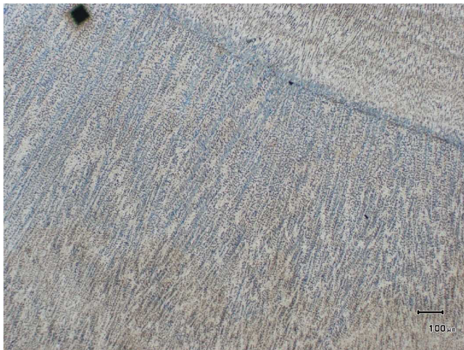
Obr. 92 Mikrostruktura svarového kovu v kořenové části svaru
