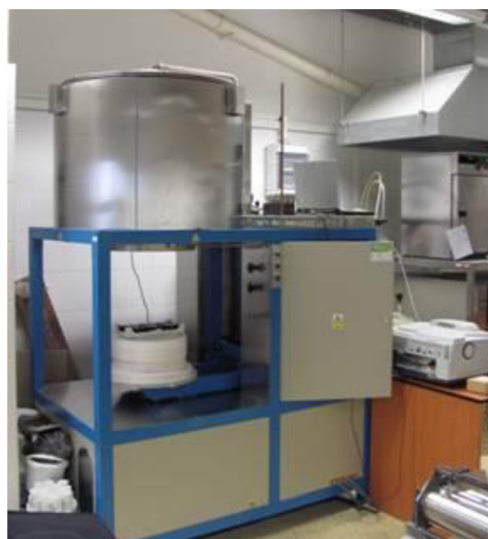
Obr. 3.7 - Feritová jádra E65/MZ24 rozložena na pálicí pomůcce a pec Clasic s řízenou atmosférou, propojená s infračerveným spektrometrem iS10.
