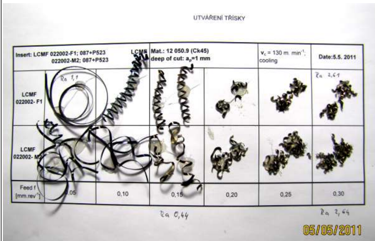
Obrázek 4.2 Tváření třísek při podélném soustružení v hloubce záběru a_p = 1 mm 4
