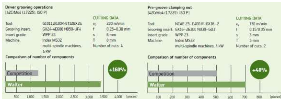
Obrázek 2.8 Porovnání trvanlivosti u povlaku Tiger.Tec 3
