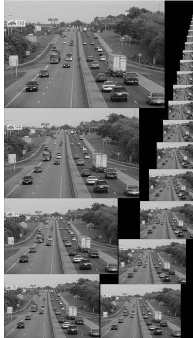
Obrázek 5.4: Pyramida obrazů je uložena v do jedné mipmapy nad kterou je provedena detekce.
