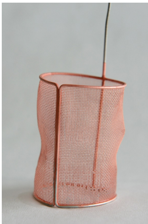
Obr. 21: Poměděná sítková platinová elektroda.
