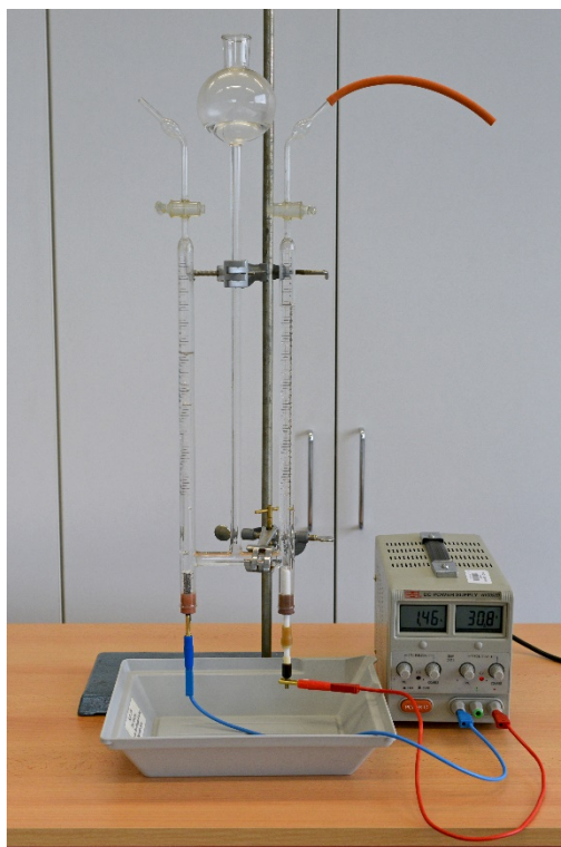
Obr. 16: Probíhající elektrolýza vody v Hofmannově přístroji (vlevo katoda, vpravo anoda).
