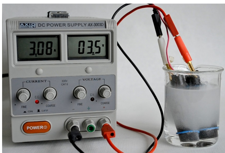
Obr. 12: Nabíjení olověného akumulátoru.
