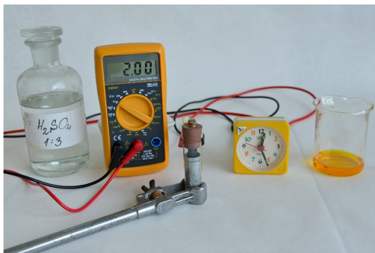
Obr. 10: Demonstrace procházejícího proudu na budíku s využitím Grenetova článku jako zdroje napětí (vpravo oranžový roztok K_2Cr_2O_7 ).
