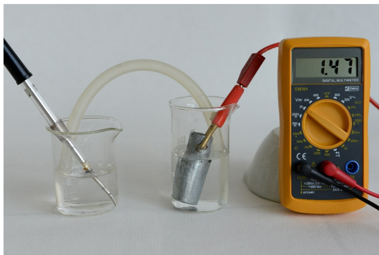
Obr. 7: Galvanický článek složený ze stříbrné a zinkové elektrody.
