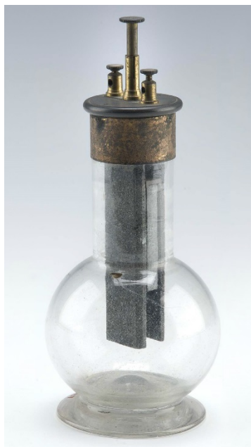
Obr. 9: Původní historický Grenetův článek (převzato z [2]).
