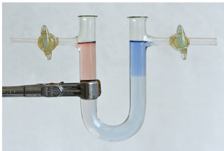
Obr. 19: Elektrolýza roztoku \text{Na}_2\text{SO}_4 s důkazem vzniklé kyseliny (červená – vlevo) a zásady (modrá – vpravo).
