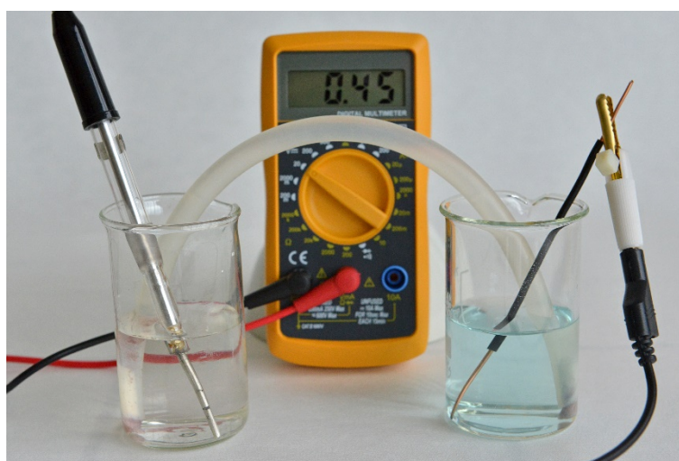
Obr. 6: Galvanický článek složený ze stříbrné a měděné elektrody.
