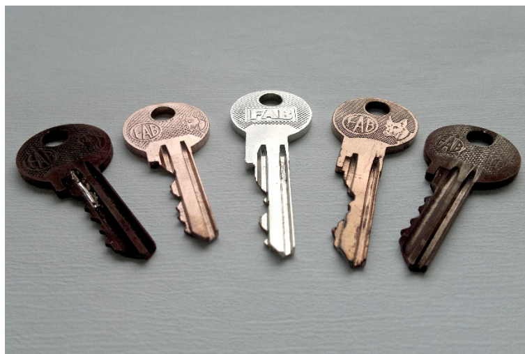
Obr. 26: Výsledek pomědování (původní klíč uprostřed).
