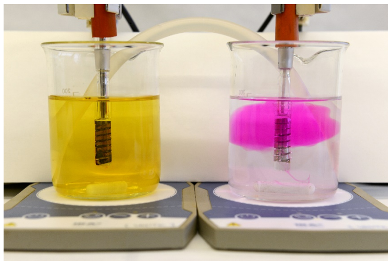
Obr. 22: Elektrolýza NaCl a KI s využitím platinových elektrod (vlevo míchající se roztok KI, vpravo roztok NaCl s barevným „mrakem“).
