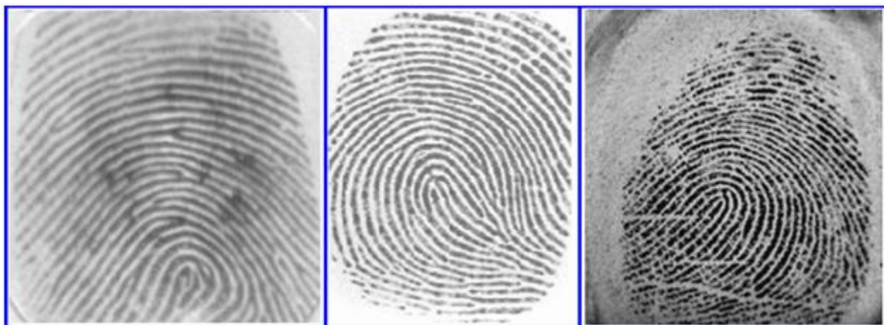
Obr. 3: A , otisk z databáze FCS 2000 Maltoni, kapacitní senzor; B , otisk z databáze FCS 2000 Maltoni, kapacitní senzor; C , otisk z databáze FCS 2000 Maltoni, optický senzor.
