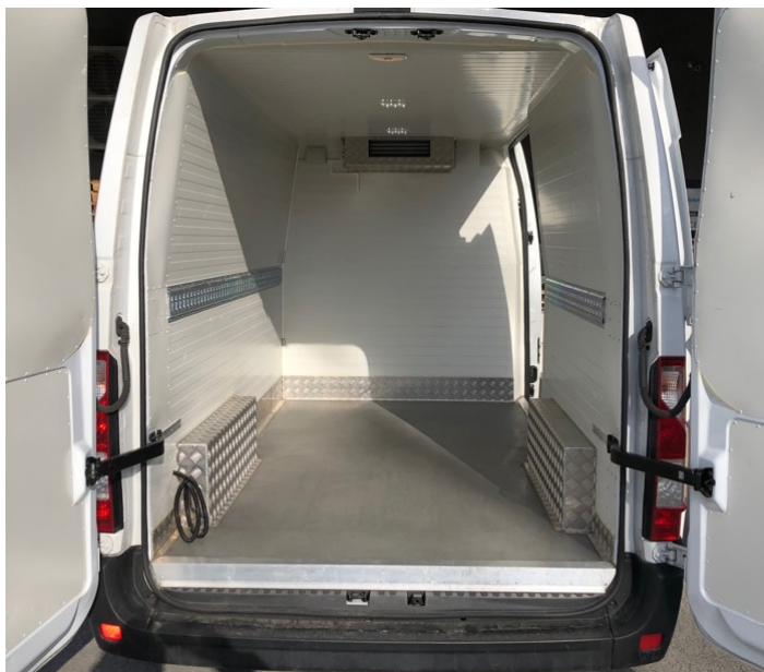
Obr. 2.3 Izotermická izolace nákladového prostoru
