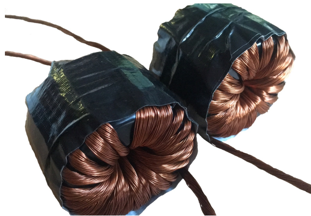
Obr. 5.5: Tlumící induktory vinuté VF vodičem
