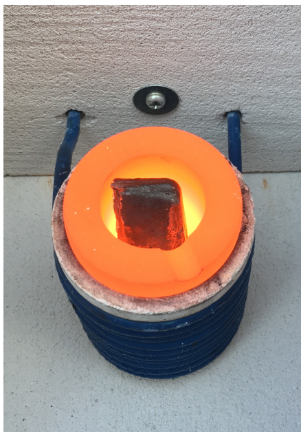
Obr. 2.1: Pracovní cívka z indukční tavící pece se zátěží
