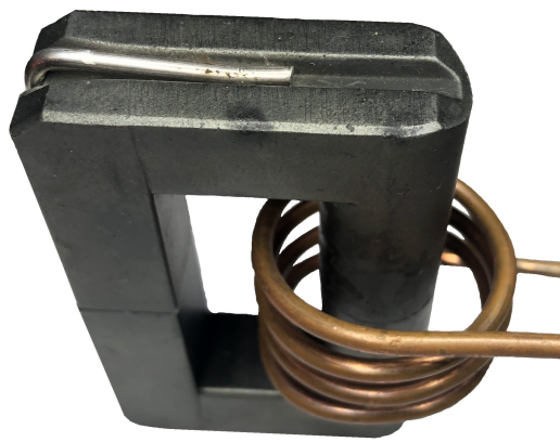
Obr. 3.3: Navinutý rezonanční induktor s feritovým jádrem
