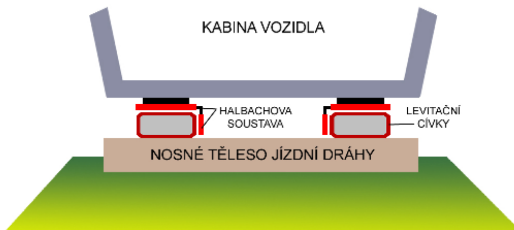
Obr. 27 Inductrack – projekt magneticky levitovaného vozidla
