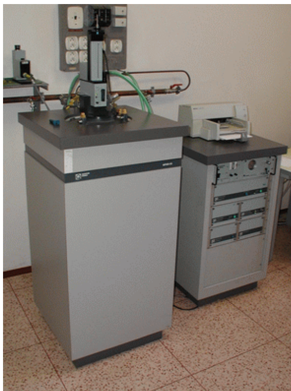
Obr. 11 SQUID - Superconducting Quantum Interference Device - k měření magnetických vlastností supravodičů a jiných materiálů
